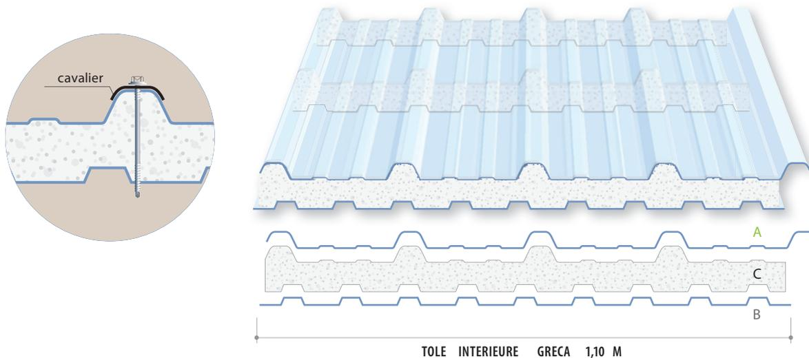
**APPLICATION** Tôles translucides de toiture**EXÉCUTION STANDARD**
